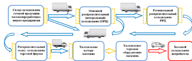
Рис. 1. НХЦ обращения охлажденных и замороженных молочных продуктов: □ – контролируемые звенья НХЦ (холодильные камеры, рефрижераторный транспорт, торговое оборудование); □ – контролируемые/неконтролируемые элементы НХЦ (охлаждаемые/неохлаждаемые погрузочно-разгрузочные платформы и эстакады); □ – неконтролируемое звено НХЦ (транспортирование и хранение СПП покупателем)
