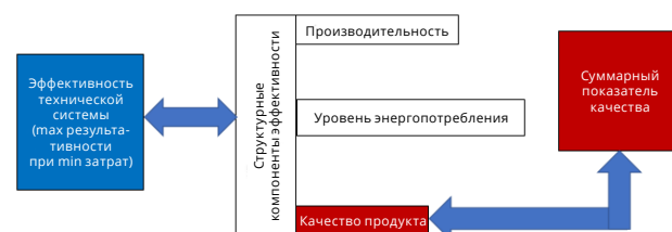
Рисунок 2. Структурная схема эффективности функционирования технологической линии по производству полутвердых сыров
