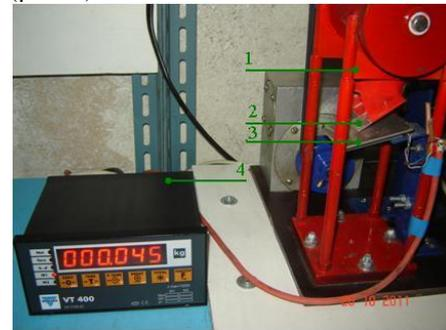
Рис. 5. Система регистрации материалотоковых сигналов: 1 – барабанный дозатор; 2 – лоток; 3 – тензометрический преобразователь; 4 – весоизмерительный преобразователь
