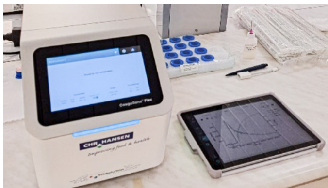
Рис. 3. Прибор «CoaguSens Flex™» для определения момента разрезки коагулированного сгустка в автоматическом режиме
