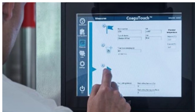
Рис. 4. Прибор непрерывного действия «CoaguTouch™» для определения момента разрезки коагулированного сгустка
