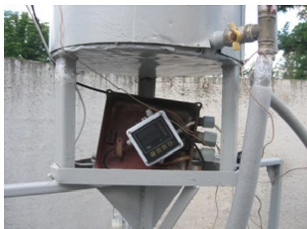
Рисунок 2 – Общий вид системы замера температурных данных на КЭУ
