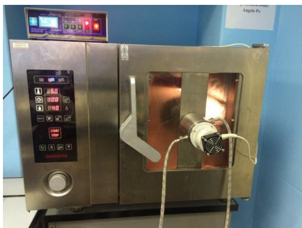
Рисунок 1. Пароконвектомат с ультразвуковым аппаратом
